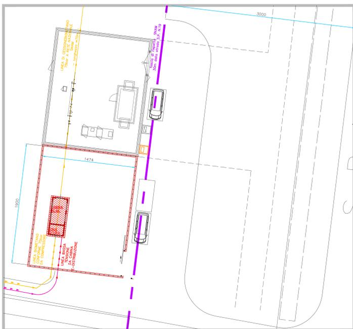
Planimetria opere connessione SNAM in progetto – scala 1:200
